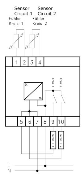
Maximal 18 Thermo E pro Heizkreis ! Maximum 18 thermo E per heating circuit!
